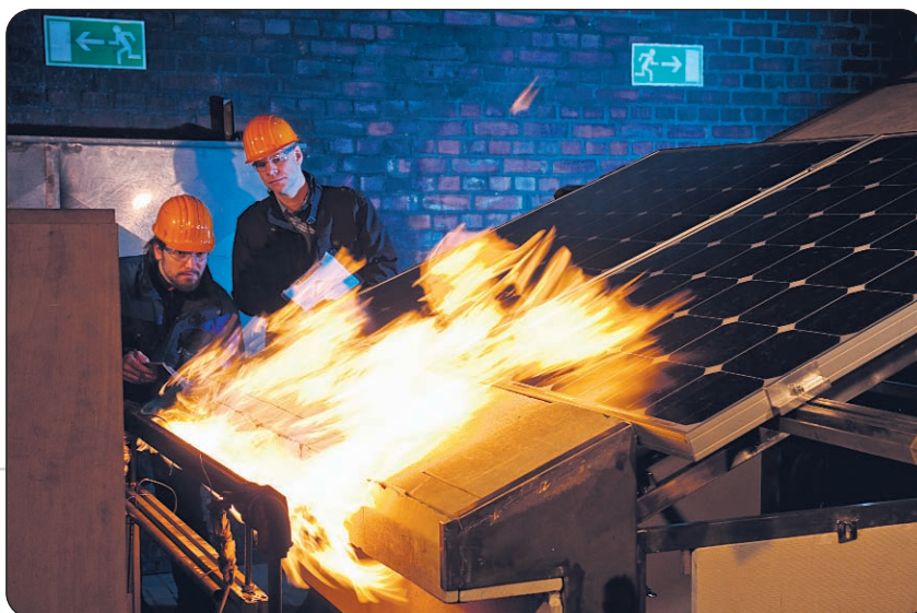
Bild 3: Brandschutz an Solaranlagen: der TÜV Rheinland führt gemeinsam mit den Fachleuten von Currenta in Leverkusen Brandschutztests an Solarmodulen durch
